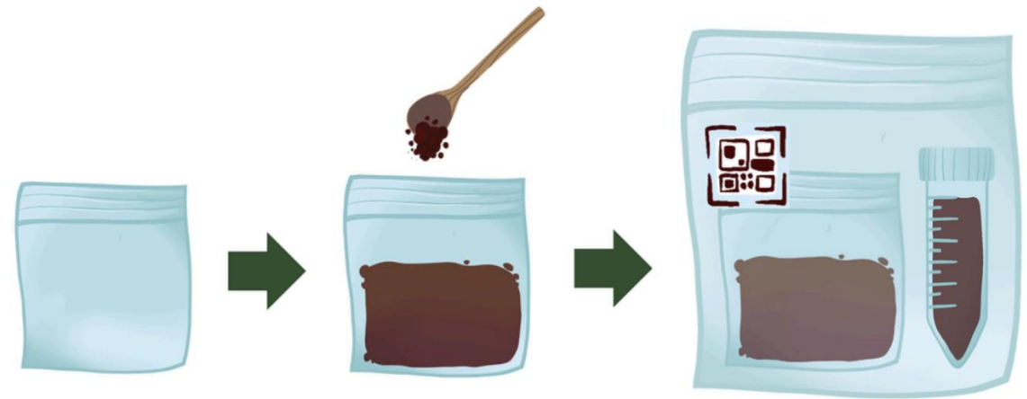
Σχήμα 8: Διαδικασία συλλογής δείγματος εδάφους για την αξιολόγηση των βαρέων μετάλλων και των θρεπτικών ουσιών εκτός του πεδίου.
